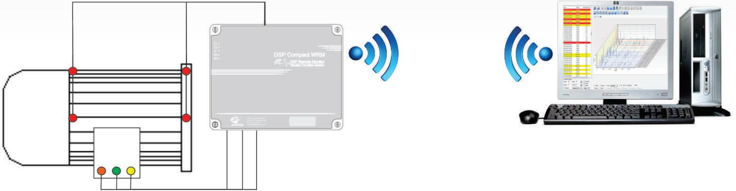
Además si el nivel global de vibraciones ha superado el umbral que usted fijó, se activaran avisos y podrán ser activadas protecciones locales o la detención inmediata del motor.
